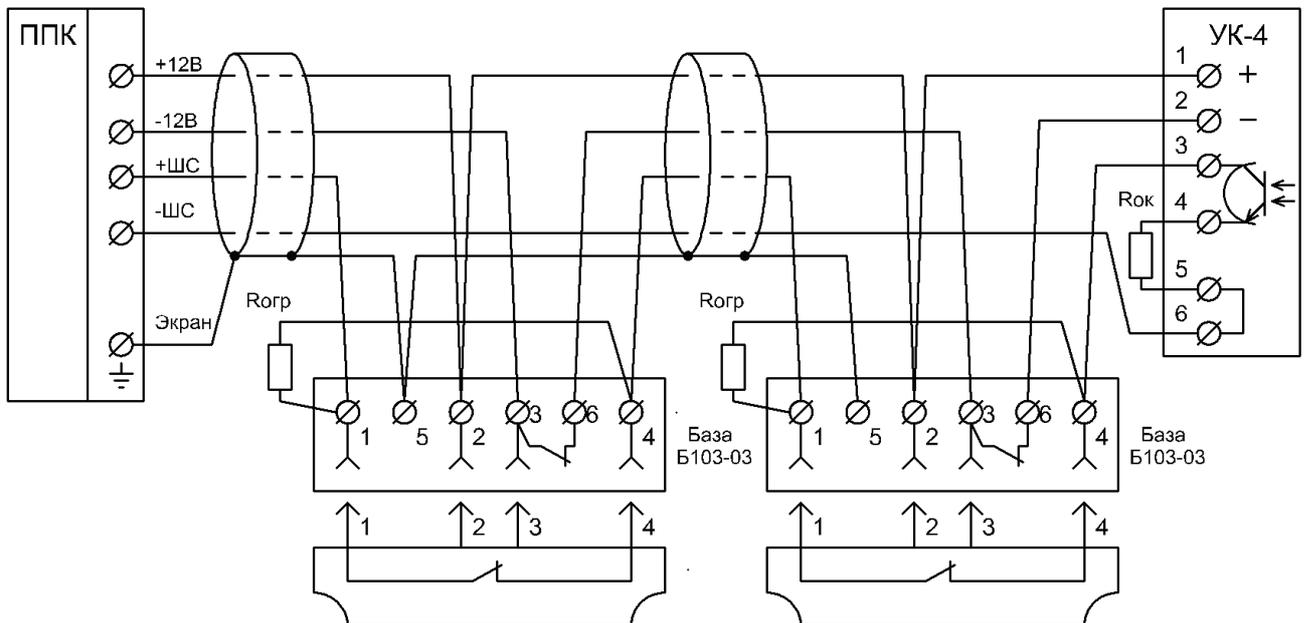
Количество извещателей в ШПС и величина  $R_{огр}$  определяется типом ППКП. При выборе номинала резистора  $R_{ок}$  необходимо учитывать, что падение напряжения между контактами «3» - «4» «Устройства конечного УК-4» составляет 1,5 В. Контакты «6» и «3», расположенные на базе, образуют размыкающий контакт. При отсоединении извещателя от базы контакты «6» и «3» размыкаются и формируется сигнал «НЕИСПРАВНОСТЬ» (разрыв ШС).
